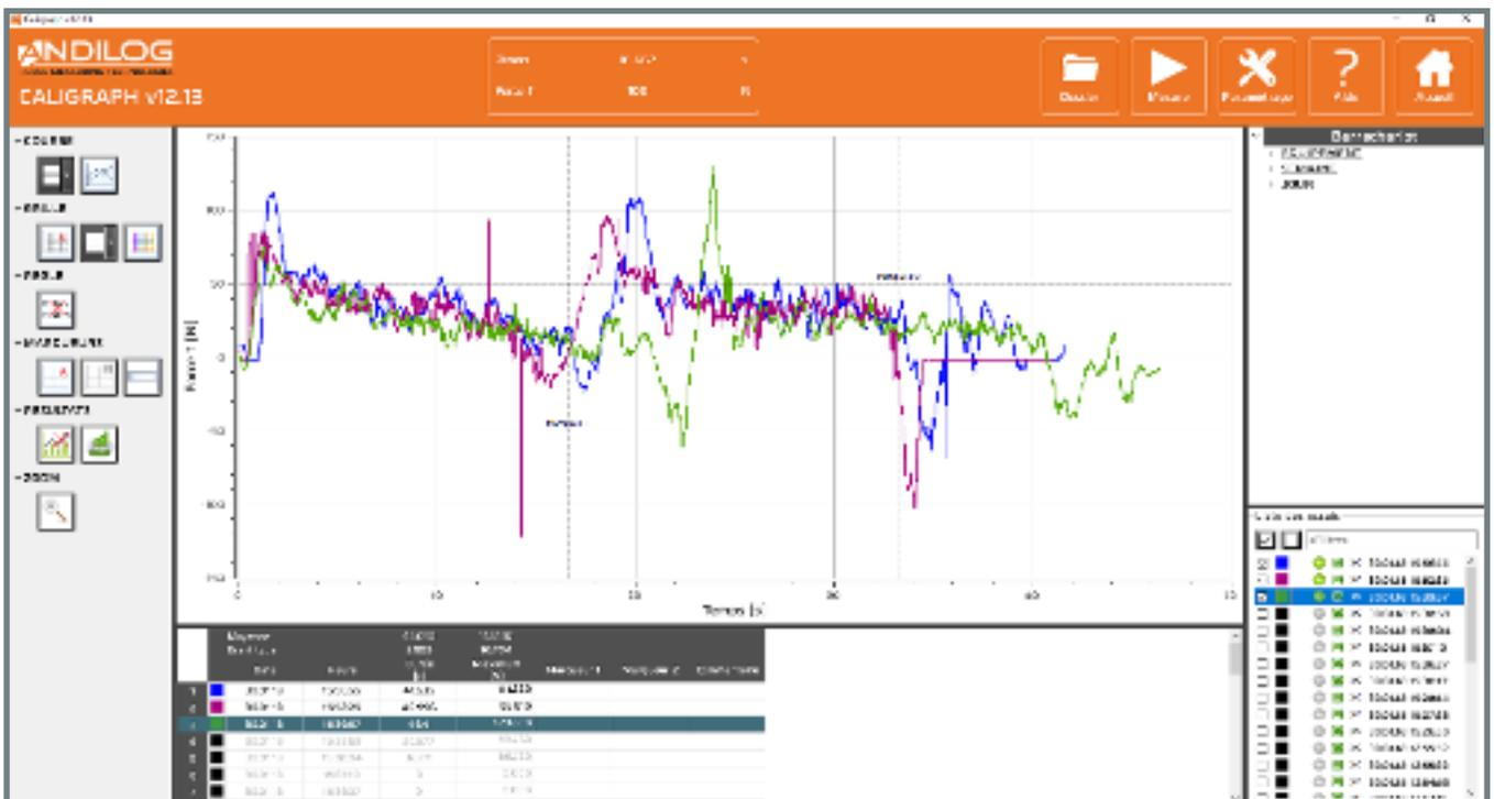
Los sensores inalámbricos WLC pueden conectarse a un ordenador mediante Bluetooth y el software de adquisición y análisis Caligraph. Puede monitorizar la evolución de sus curvas de fuerza y par en tiempo real, registrar sus datos, calcular automáticamente sus resultados y editar informes de pruebas personalizables.
