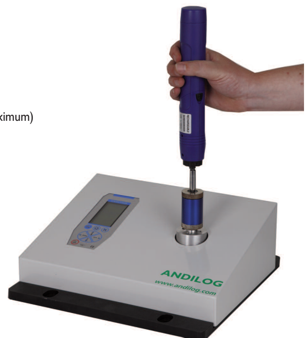
CENTORMETER EA avec simulateur de vissage pour le contrôle des visseuses
